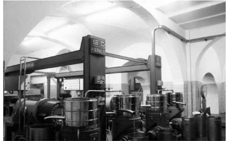
*La tappa ulteriore porta al superamento delle macine e dell'impianto Alfa Laval sostituiti da due linee a ciclo continuo Peralisi.*
