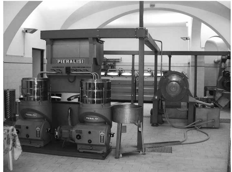
*Nel 2005 si è avuta una semplificazione con un'unica linea Peralisi tutta in acciaio inox e sensori per il rispetto delle temperature nelle diverse fasi.*
